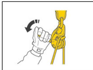
Evacuación gracias al descensor I'D EVAC, cuya empuñadura ergonómica permite controlar fácilmente la circulación de la cuerda durante la evacuación.
