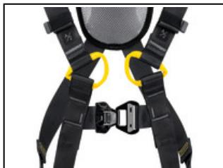
La hebilla automática FAST LT PLUS esternal permite abrir y cerrar fácil y rápidamente, sin perder la regulación, incluso con guantes. Ligero y resistente, el punto de enganche esternal textil permite la conexión de un sistema anticaídas.
