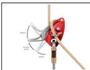
Si el usuario tira demasiado fuerte de la empuñadura, la función antipánico frena y detiene automáticamente el descenso.
